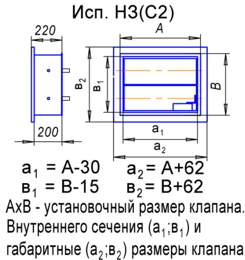
Рис.1. Установочные, габаритные и размеры внутреннего сечения клапана.
