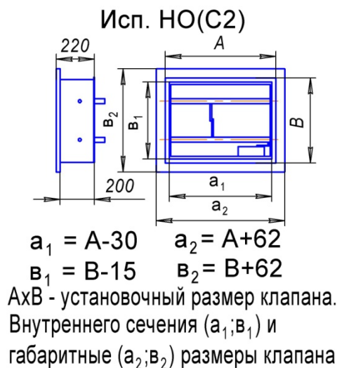
Рис.1. Установочные, габаритные и размеры внутреннего сечения клапана.
