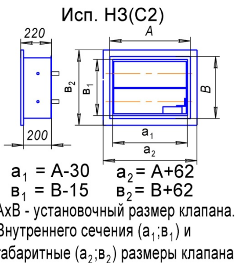
Рис.1. Установочные, габаритные и размеры внутреннего сечения клапана.
