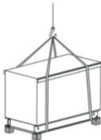
14.6 транспортировка краном — крепление при помощи лент
