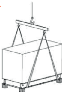
14.в транспортировка более тяжелых установок при помощи траверсы
