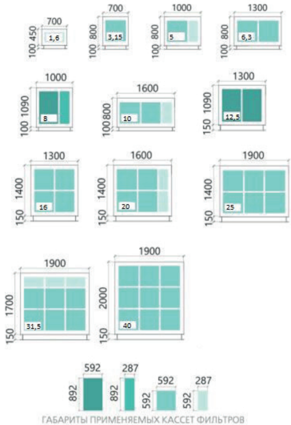
КОЛИЧЕСТВО И РАЗМЕРЫ ФИЛЬТРОВ В СЕКЦИЯХ ФИЛЬТРОВ ЦЕНТРАЛЬНЫХ КОНДИЦИОНЕРОВ СИВА
